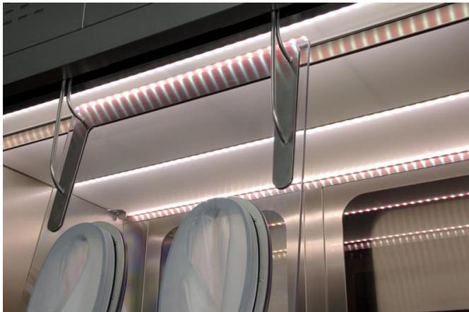
*Farbige LED-Lichter signalisieren den Betriebszustand der Anlage und warnen vor Störungen.*
