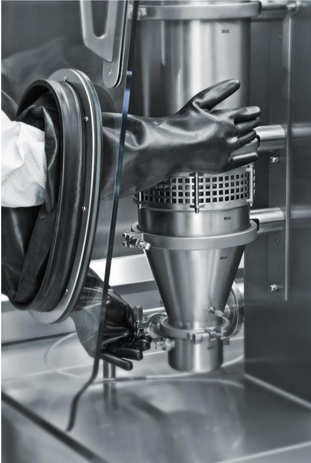
*Abb. 2: Wibelschichtenanlage Mini/Midi von Glatt integriert in einem WIBObarrier® Containment System von Weiss Pharmatechnik.*
